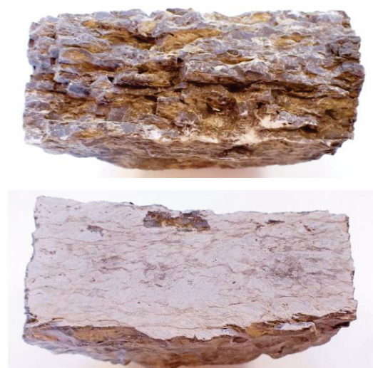
Abbildung 2-1: Vergleich verschiedener Probenoberflächen einer Probe aus flaserigem Kalkstein: oben die durch Aufspalten hergestellte, nicht zur Prüfung geeignete, „bruchraue“ Oberfläche, unten die durch trockenes Sägen hergestellte „sägeraue“ Probe.
