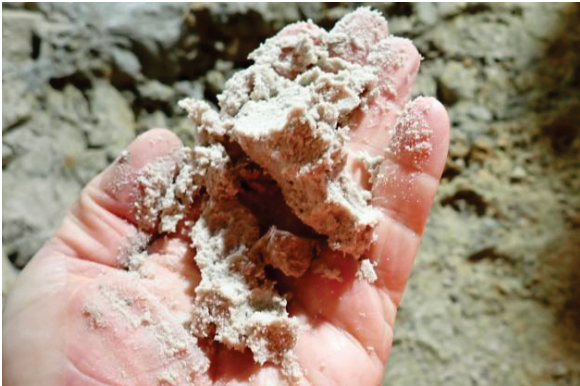
Abbildung 3-3: Typisches Erscheinungsbild der vollständig hydrothermal zersetzten und gebleichten Sandsteine (X1).
