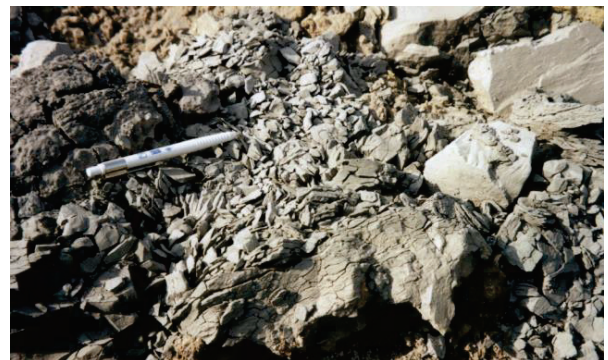
Abbildung 2-1: Tonmergelstein als Beispiel eines veränderlich festen Gesteins mit hoher Zerfallsneigung (Foto: Nickmann 2000).
