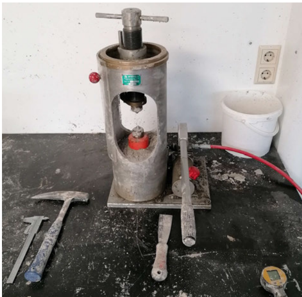
Abb. 6: Einsatz des Punktlastversuchs auf der Baustelle (Foto: ARGE Geotechnik B51).
