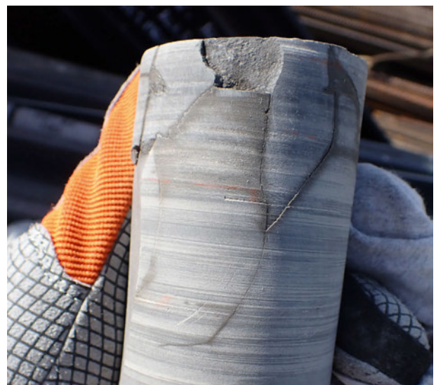
Abb. 1: Haarrisse in einem Mergelstein. Das Vorhandensein derartiger Risse macht die Festigkeitsprüfung an einem solchen Probekörper obsolet (Foto: Plinninger).
