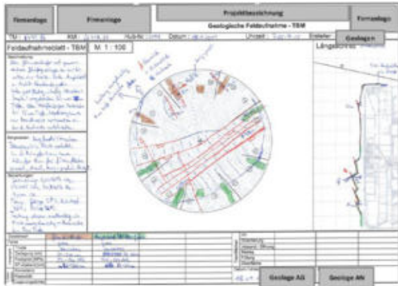
Abbildung 2-3: Beispiel für eine einvernehmliche Aufnahme an der Ortsbrust eines TVM-Vortriebs im Festgestein (ÖGG-Empfehlung, Anlage A2-3).
