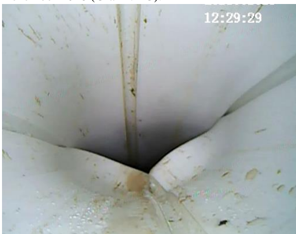
Abb. 5: Ergebnis einer Videobefahrung in Messstelle B32 bei ca. 3,1 m u. GOK: Das Inklinometer-Messrohr wurde aufgrund der hohen Verformungsbeträge an der Scherfuge bis zur Unbrauchbarkeit deformiert (Foto: PG).
