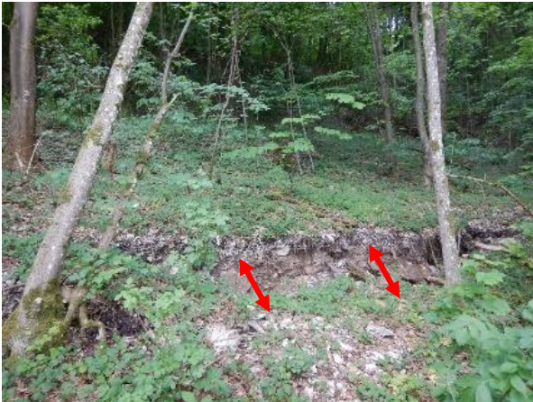
Abb. 2: Frische Bodenrisse und gespannten Wurzeln im bewaldeten Hang oberhalb der Baugrube, Frühjahr 2018 (Foto: BBB).
