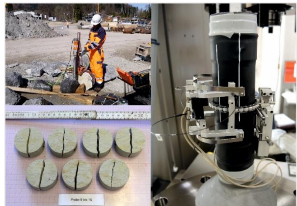
Abb. 1: Für die Buchveröffentlichung erstellte Fotocollage, die das Tätigkeitsspektrum des AK 3.3 versinnbildlichen soll: Im Uhrzeigersinn: Probenahme im Gelände, Triaxialversuch in der Prüfanlage und Probekörper eines Spaltzugversuchs nach Versuchsdurchführung.
