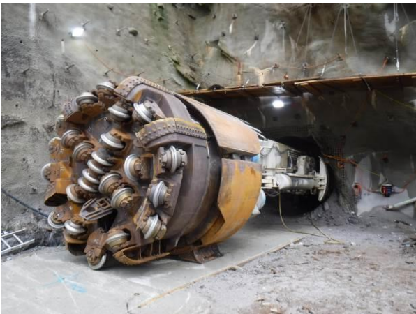
Abb. 4: Eingesetzte Tunnelbohrmaschine Robbins nach erfolgtem Durchschlag des zweiten Stollenastes DS Zemmgrund-Stillupp (Foto: Pöry Austria GmbH)
