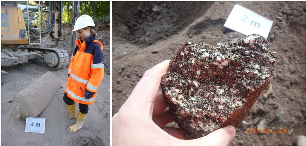
Abb. 9 Dokumentation von Bohrpfahlbohrungen im Fels: Links Kerngewinn im frischen Diorit mithilfe des Kernbohrrohrs. Rechts: Dokumentation von Schlüsselbeobachtungen an Bohrgut unter Einsatz der „Teufentafel“ (im Hintergrund).
