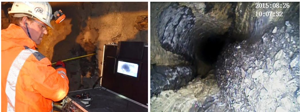
Abb. 2 Beispiel für den Einsatz eines Bohrlochinspektionssystems zur Karstvorerkundung in Erkundungsbohrungen bei einem Tunnelvortrieb im Germanischen Muschelkalk.
