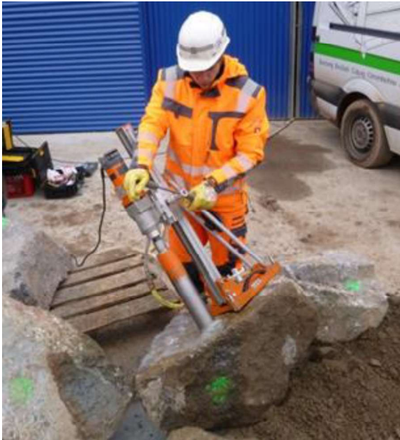
Abbildung 4-3: Beispiel für die Gewinnung orientierter Proben durch Überbohren einer Blockprobe vor Ort mittels tragbarer Betonkernbohrausrüstung (Schwarzkopftunnel, 2015).
