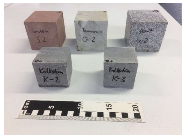
Abbildung 2-1: Würfelförmige Probekörper der vier im CERCHAR-Ringversuch getesteten Lithologien (v.l.n.r.: Sandstein, Quarzit, Granit, Kalkstein).
