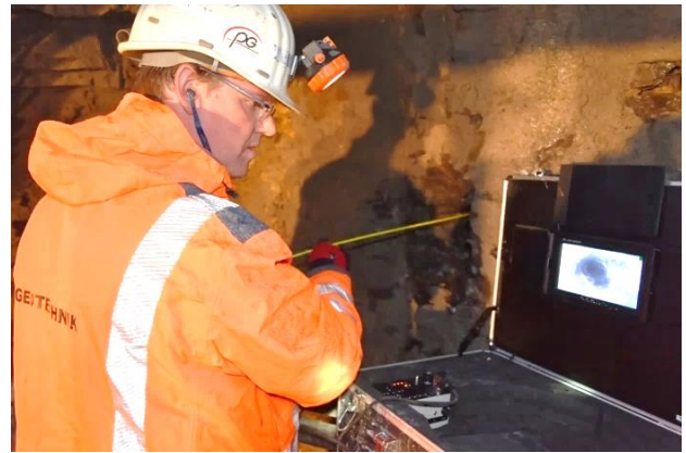
Bild 11: Einsatz des Bohrlochinspektionssystems für eine Erkundungsbohrung im Haupttunnel.
