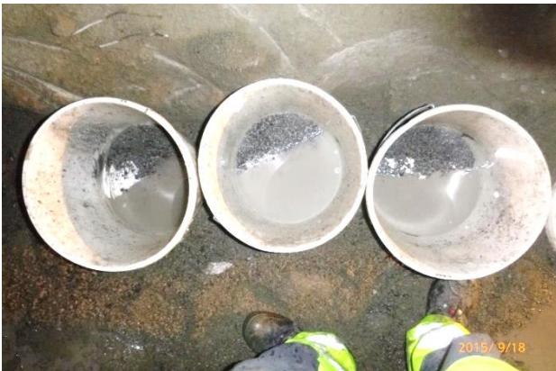
Bild 10: Beispiel für die Dokumentation des Bohrspülrücklaufs mittels Kübelproben.
