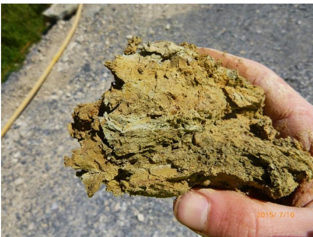
Bild 7: Bindige Karstlehme aus der Karststruktur im Rettungstollen, TM 26,0 am 10.07.2015.
