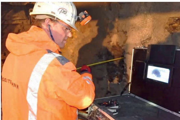
Abbildung 4-3: Einsatz des Bohrlochinspektionssystems für eine Erkundungsbohrung im Haupttunnel.
