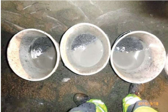
Abbildung 4-2: Beispiel für die Dokumentation des Bohrspülungsrücklaufs mittels Kübelproben.
