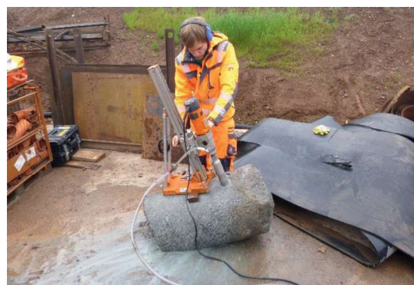
Abbildung 8: Gewinnung von Probekörpern für felsmechanische Laboruntersuchungen aus mittels Kernbohrer gewonnenen Grobbohrkernen.
