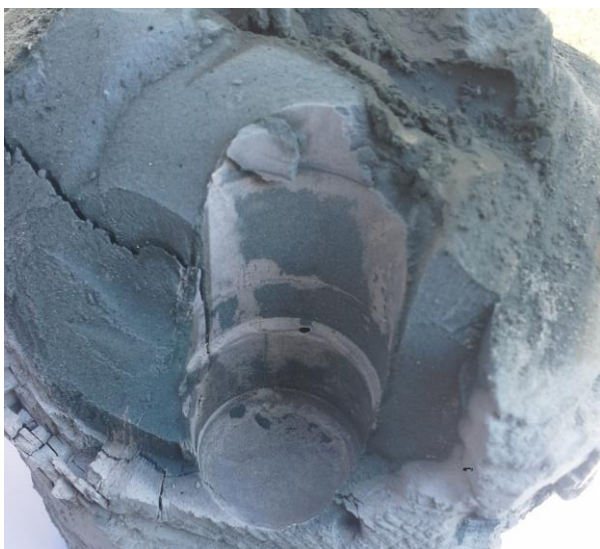
Bild 10: Randlich ausgetrocknete Probe P01: Deutlich erkennbar sind Trocknungsrisse und deutlich helleres Material im Randbereich.
