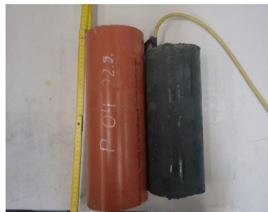
Bild 6: Probe P04 aus handelsüblicher Bohrlöchsuspension (rechts) nach dem Entfernen aus der Schalung (braunes KG-Rohr, links).
