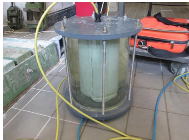
Bild 8: Plexiglas-Druckzelle mit eingebauter Probe P04.
