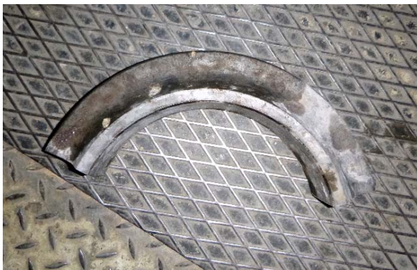
Bild 10: Gesplitteter 17“-Meißelring einer Hartgesteins-Tunnelvortriebsmaschine.
