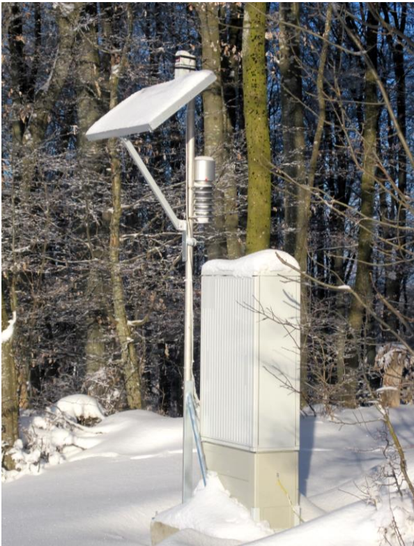
Bild 5: Autarke Datenerfassungsstation. Erkennbar der GFK-Schrank für Loggereinheit, Laderegler und Pufferakku sowie der 3,0 m hohe Mast mit Solarpaneel und GSM-Antenne.
