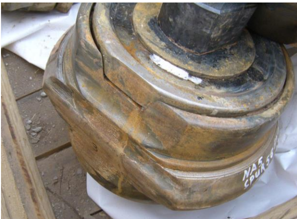
Bild 1: Beispiel einer verschlissenen Einringdiske
