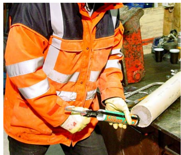
Bild 7: Setzen einer Silikonplombe bei einer in einem Mehrfachkernrohr mit Inliner gewonnenen Tonmergelsteinprobe (Foto: Plinninger)
