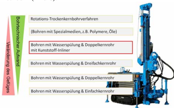
Bild 6: Übersicht über Kernbohrverfahren, ihren bohrtechnischen Aufwand sowie die mögliche Veränderung des Gefüges bei der Gewinnung veränderlich fester Gesteine.
