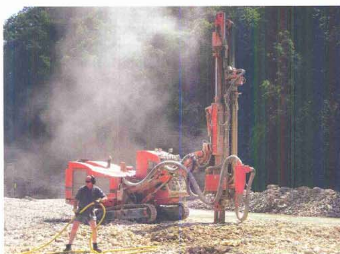
Bild 2. Bohrgerät Tamrock Pantera 1100 im Einsatz Fig. 2. Tamrock Pantera 1100 Drill Rig in operation
