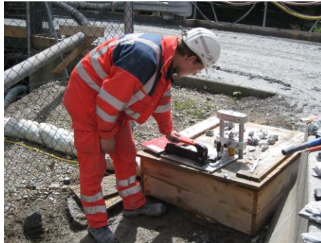
Bild 6: Punktlastversuch vor Ort. Durch die Anwendung dieses indirekten Prüfverfahrens an unregelmäßigen Handstücken („irregular lump test“) konnten zeitnah und in ausreichender Menge repräsentative Indexwerte für die Einaxiale Druckfestigkeit ermittelt werden (Foto: Plinninger).
