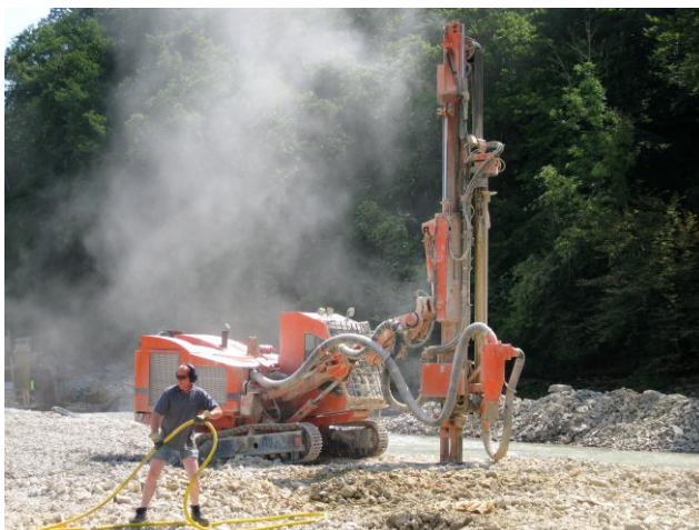
Abb. 2: Bohrgerät Tamrock Pantera 1100 im Einsatz.
