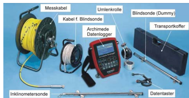
Bild 2: Beispiel für ein modernes Sondeninklinometer-System (Foto: SISGEO s.r.l.)
