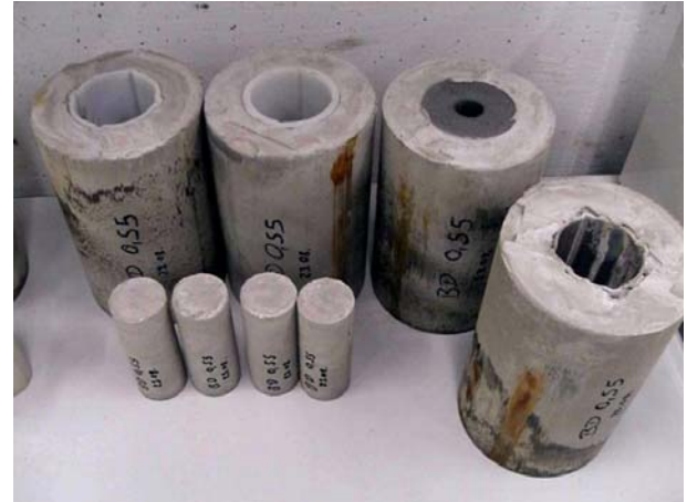
Bild 7: Beispiel für den kompletten Probensatz eines Verfüllmediums (hier: Verfüllmedium Blitzdämm® mit einem W/Z-Faktor von 0,55) mit verschiedenen Messrohren und Probekörpern für ein- und dreiaxiale Druckversuche.
