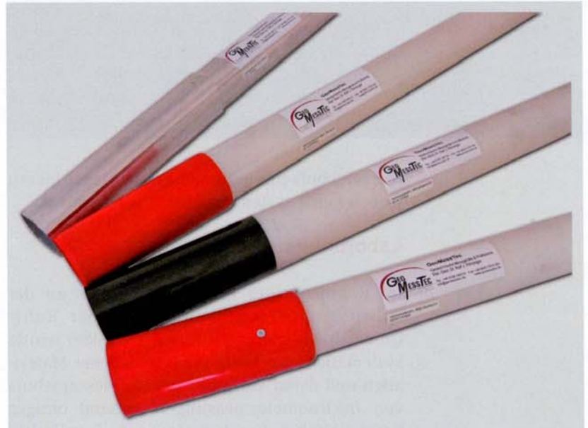
Bild 3. Auswahl unterschiedlicher Inklinometermessrohre (von oben nach unten): Aluminiumrohr mit 76 mm Durchmesser, ABS-Rohr mit 71 mm Durchmesser und 3,5 mm Wandstärke, ABS-Rohr mit 70 mm Durchmesser und 5 mm Wandstärke und durchmesserkonstanter Muffe, ABS-Rohr mit 70 mm Durchmesser und 5 mm Wandstärke und Schnellkupplungssystem.
