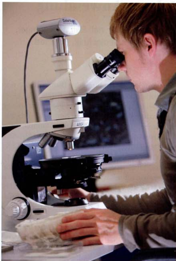
Bild 1. Mineralbestandsanalyse im Dünnschliff mit dem petrografischen Mikroskop (Quelle: TU Graz/Bergmann).
