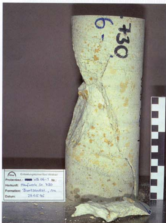
Bild 2. Sandstein-Probekörper mit typischem Bruchbild nach einaxialem Druckversuch.
