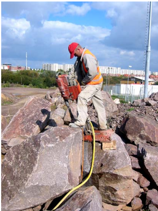
Abb. 10: Entnahme von Bohrproben mit Betonkernbohrgerät aus Syenit-Haufwerksblöcken auf Deponie (Tunnel Dölzsch, Dresden). Fig. 10: Core sampling from blasted rock debris (syenite) with concrete core drilling device (Dölzsch tunnel, Dresden/Germany).
