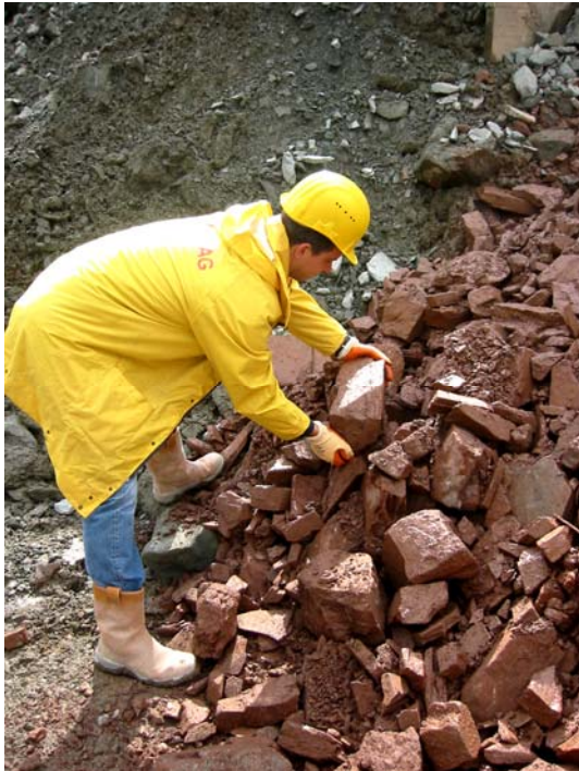
Abb. 9: Entnahme von frischen Tonschieferproben von Zwischendeponie (Schlossbergtunnel, Dillenburg). Fig. 9: Sampling of fresh slate from the muck pile (Schlossberg tunnel, Dillenburg/Germany).
