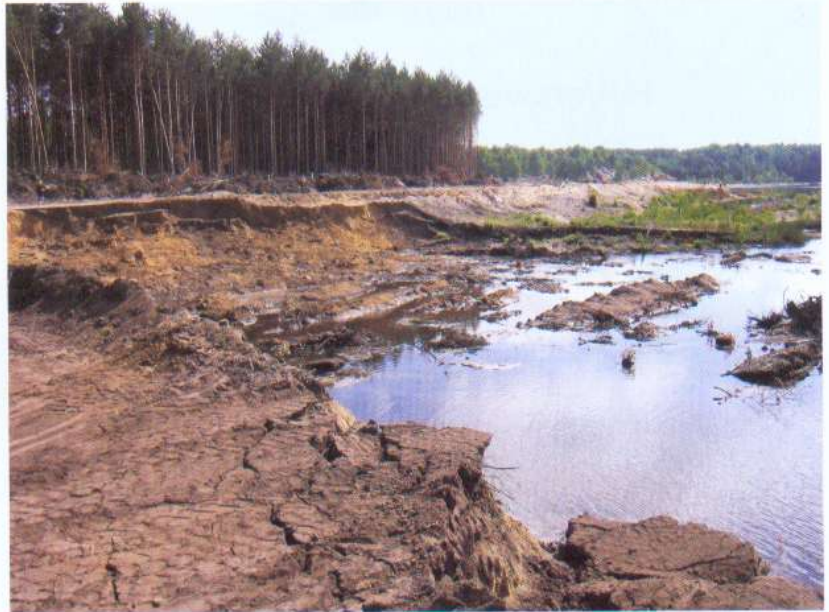
Bild 2. Setzungsfließversagen im Vorfeld einer Rütteldruckverdichtung. Höhe der Abrisskante etwa 4 m. Der bereits verdichtete Damm links im Bild blieb erhalten.
