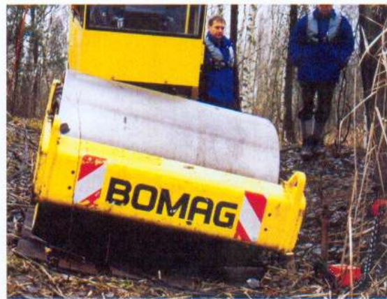
Bild 8. Beispiel für ein eingesacktes Versuchsgerät während eines Versuchs.
