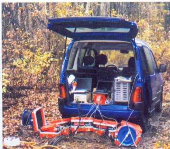
Bild 6. Mobiler „Kontrollplatz“ vor Versuchsbeginn. Die Ergebnisse der Porenwasserdruck- und Erschütterungsmessungen laufen auf zwei Notebooks auf, ebenso werden von hier die 200 m entfernten Erregergeräte ferngesteuert.
