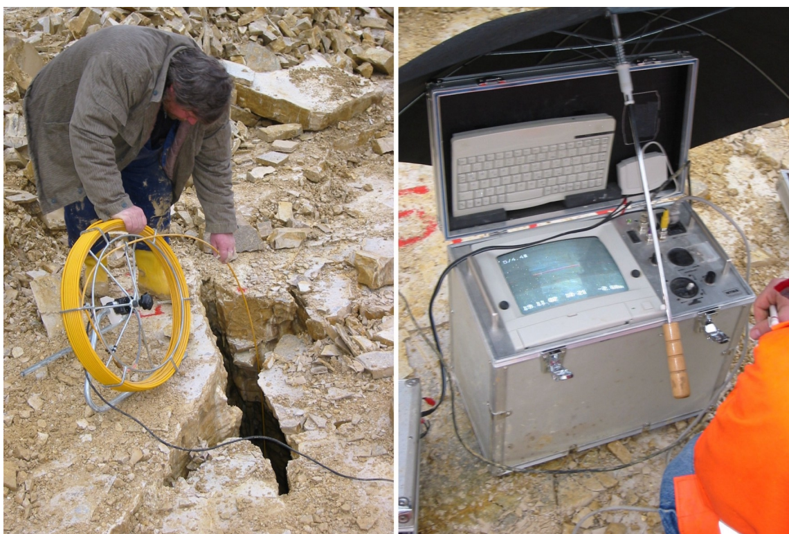
Abb. 12: Kamerabefahrung offener Spalten in der Einschnittsohle.
