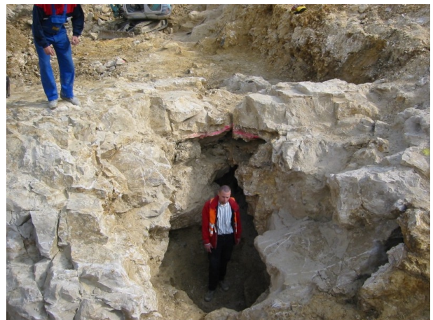
Abb. 4: Typische Ausbildung der Felsoberfläche im Bereich massiger, dolomitischer Kalken. Die unregelmäßig brechenden Dolomitesteine sind z. T. metertief von unregelmäßig-schlauchförmigen Karstspalten und Hohlräumen durchzogen. Bildbreite ca. 6 m.
