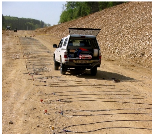
Abb. 8: Ausgelegte Geophonkette für seismische Karsterkundung.
