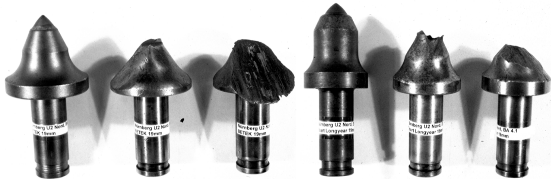
Abbildung 4: Gegenüberstellung fabrikneuer und typisch verschlissener Rundschaftmeißel zweier Hersteller bei einem Vortrieb mit mehreren, bis zu 1,5 m mächtigen „Steinmergellagen“. Jeweils links der fabrikneue Meißel, mittig ein durch Aus- oder Spröbruch des Hartmetallstifts verschlissener Meißel, rechts ein fortgeschrittenes Stadium mit einseitiger Abnutzung infolge des Spröbruchs.
