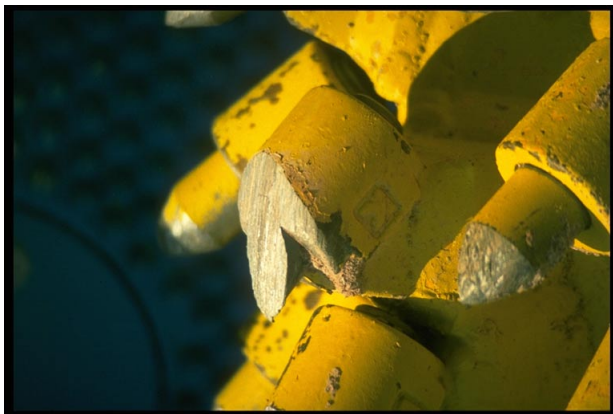
Abb. 3: Abgenutzte Außenmeißel am Querschnittskopf der Teilschnittmaschine (300 kW Schneidleistung). Fräsversuch in Fanglomeraten der Waderner Schichten.
